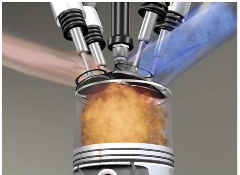
Il profilo della camma, il suo sviluppo angolare ed il suo orientamento sull'albero, devono essere tali da assicurare l'apertura e la chiusura della valvola negli istanti voluti; poiché dal punto di vista puramente teorico, la fase di aspirazione (ed anche quella di scarico) deve avere durata pari alla corsa dello stantuffo, lo sviluppo angolare del nasello dovrebbe essere tale da consentire lo svolgimento di detta fase nel tempo corrispondente a mezzo giro dell'albero motore.
